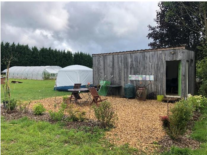
Le container dans son contexte. Il est posé sur 4 plot en ciment. Il est donc aisé pour un transporteur de passer des sangles sous le container pour le déplacer.
